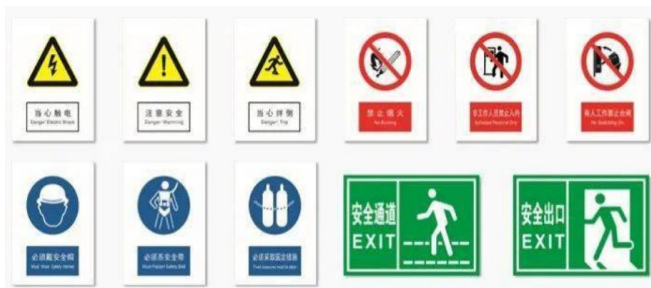
图：施工现场常用安全警示标志
