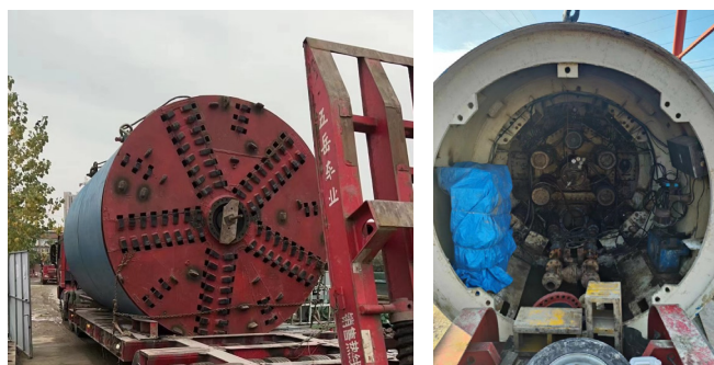
图2 本工程采用的泥水平衡顶管机
