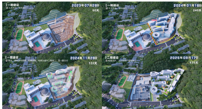
图5 BIM结合虚拟现实施工进度模拟
