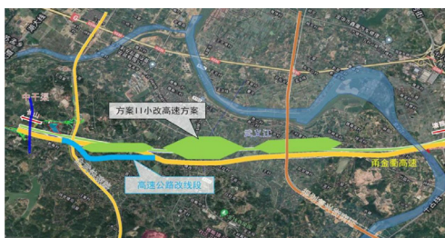
图3 方案II平面布置示意图
