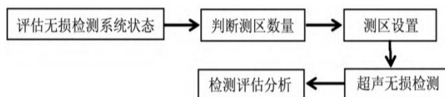
图1 超声无损探伤检测技术流程
