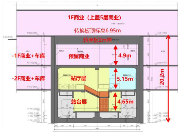
图3 车站与地块衔接横剖面示意图
