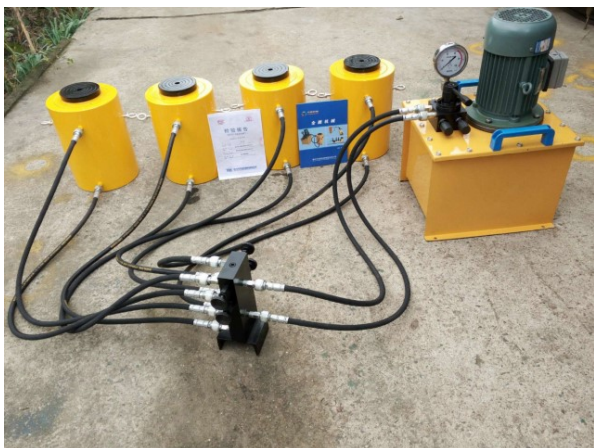
图4 顶升系统连接示意图
