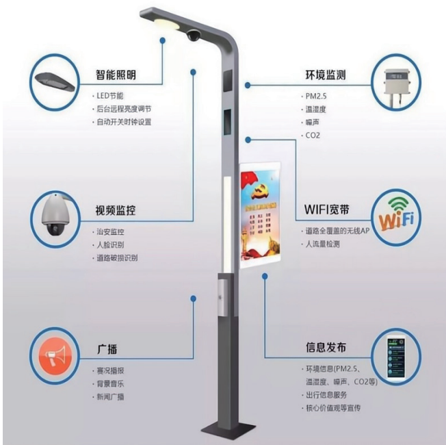
图3 快速路智慧多功能杆
