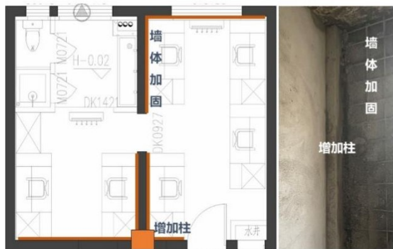
图5 墙体加固平面位置及施工照片
