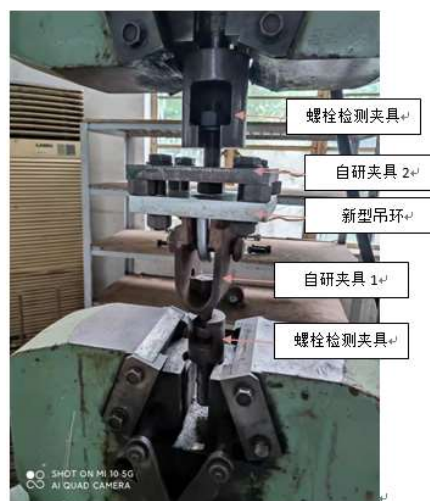
图2 吊环与夹具组合安装示意图
