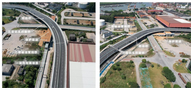
图 1.1 钢箱梁桥施工难点图
