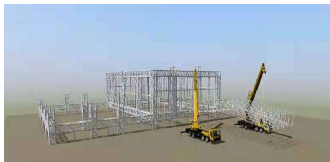
图1 网架吊装BIM模型
