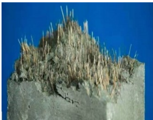
图2 钢纤维混凝土内部结构
