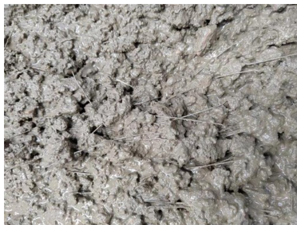
图3 钢纤维混凝土拌和
