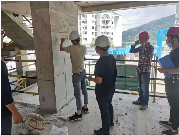
图1 利用回弹法检测混凝土结构
