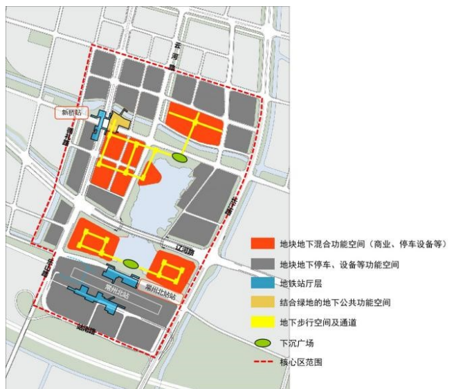
图1 核心区地下空间-1层功能规划图
