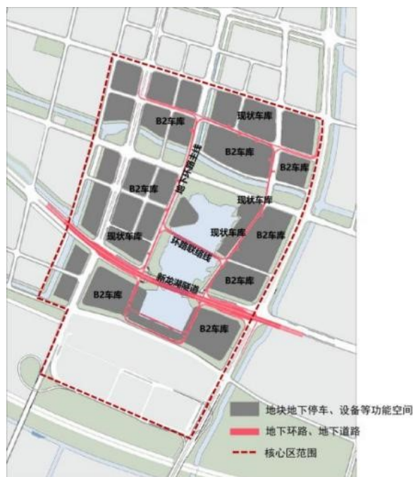
图2 核心区地下空间-2层停车系统规划图
