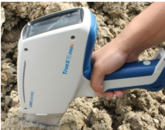
图1 X射线荧光光谱仪手持式示意图
