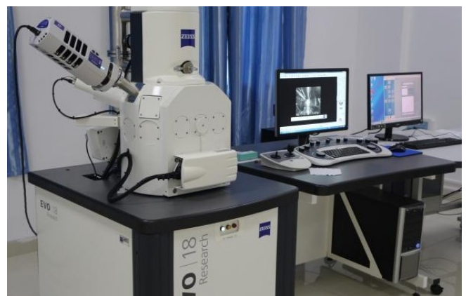
图2 砂石原材料检测中扫描电子显微镜的应用
