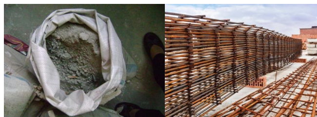
图 4.1 水泥结块、钢筋生锈
