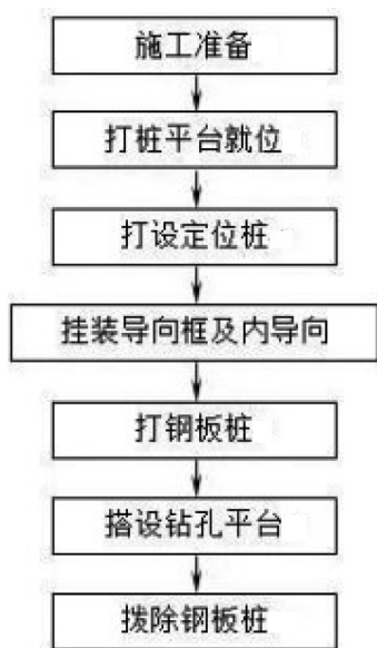
图1 钢板桩支护施工流程
