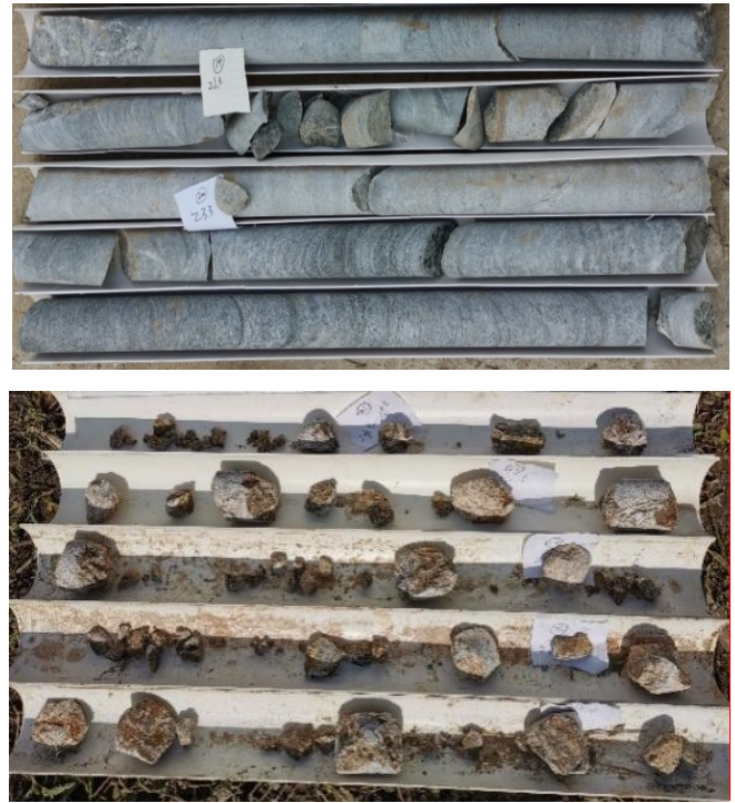
图6 验证钻孔孔内正常岩芯与破碎带岩芯对比
