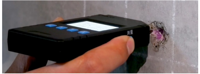
图1 酚酞检测混凝土碳化深度
