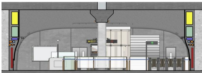
图3 站厅层集成剖面图
