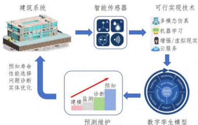
图1 基于数字孪生模型的故障监测框架
