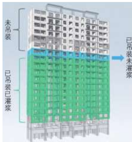
图2 构件安装进度实时监控
