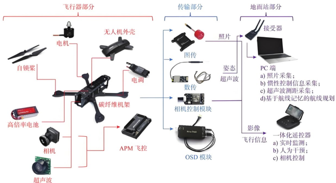
图1 无人机结构
