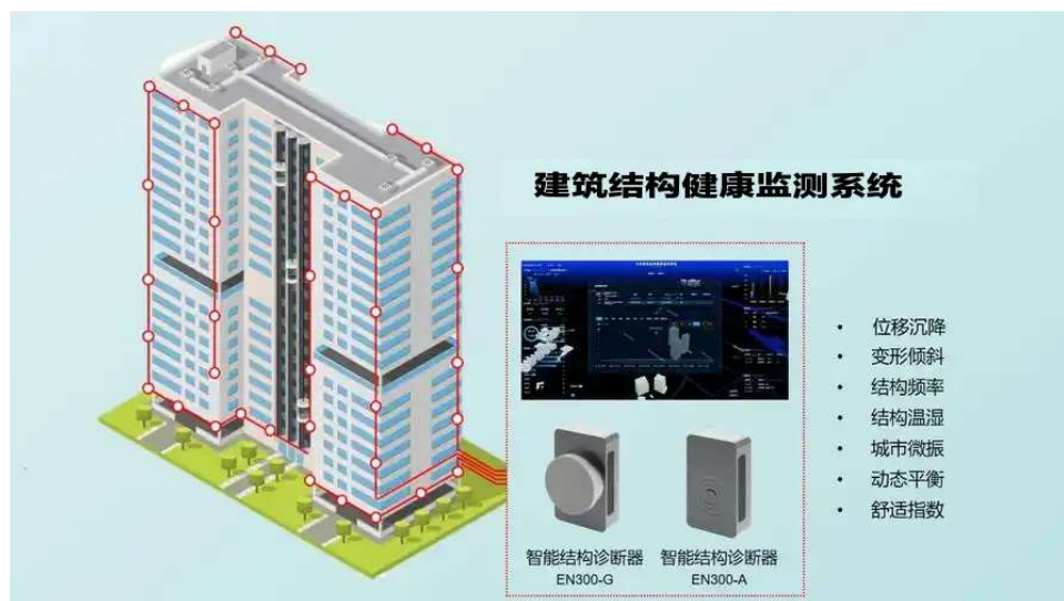
图二 建筑结构监测
