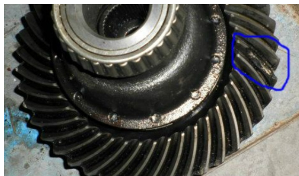
图1 施工设备磨损
