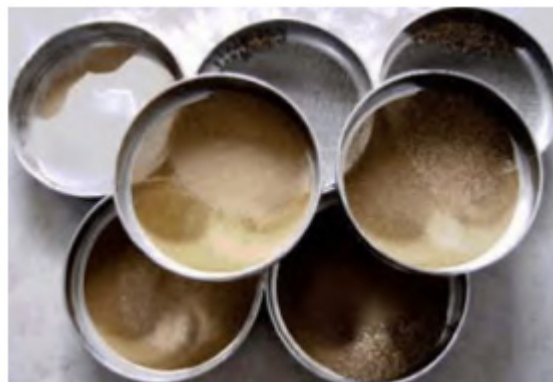
图1 细骨料过筛实验检测
