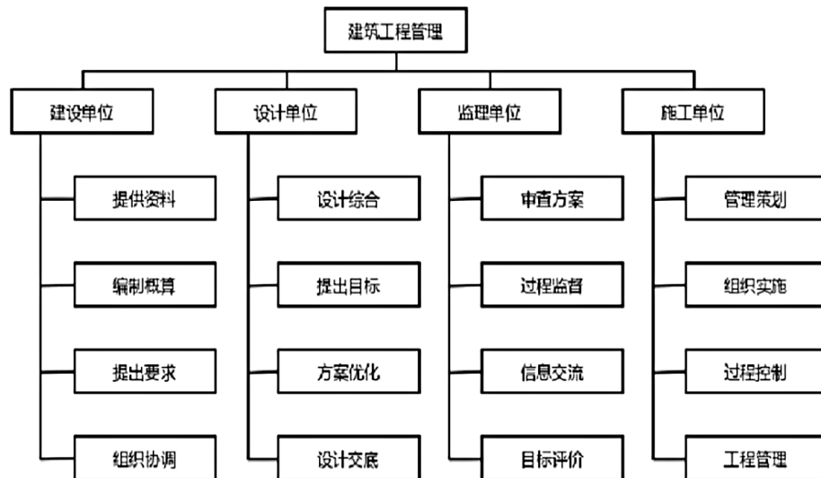
图1 建筑工程管理体系框架
