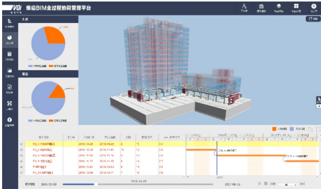
图 1 BIM 模型与施工进度计划相结合
