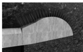
步骤5:通道挑顶段喷护成型
