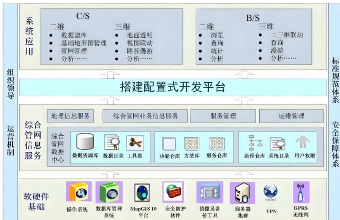
图1 GIS系统体系架构
