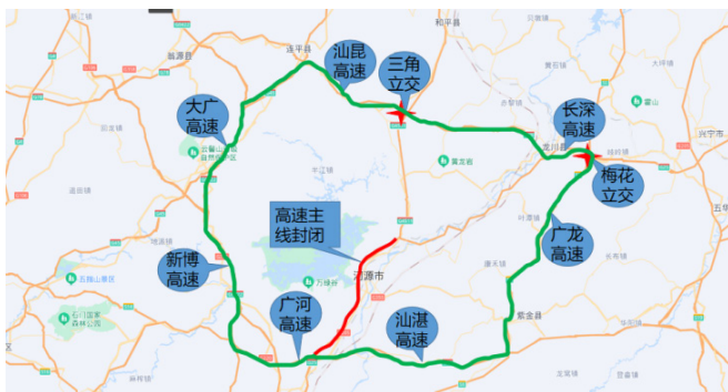
图 2 桥梁拆除高速分流示意图
