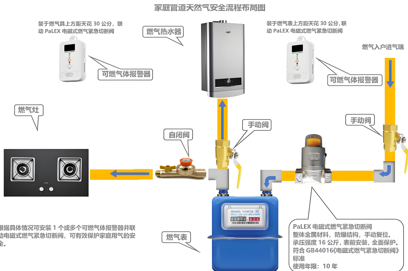
图 3：智能燃气泄漏报警器与自动切断阀安装示意图
