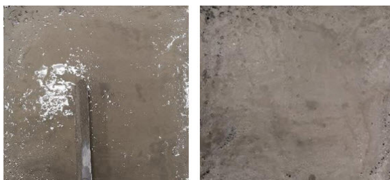
a 灌浆初始 b 干燥养护一段时间后
