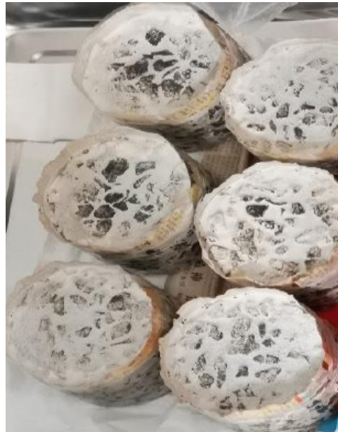
图3 马歇尔灌浆试件固化后状态
