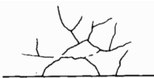
图1 变电站土建工程设备基础裂缝病害示意图
