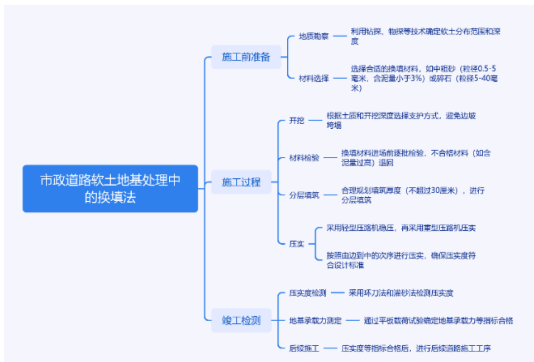
图 1 换填法施工要点
