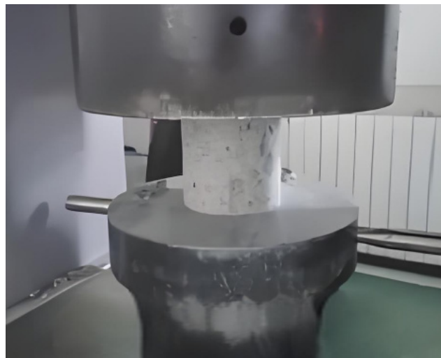
图1 混凝土抗压强度试验过程
