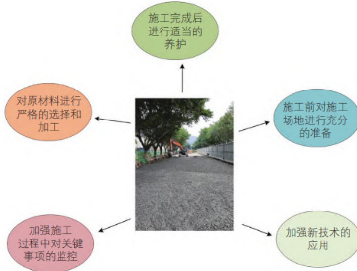
图3 水泥稳定碎石基层施工工艺的改进措施
