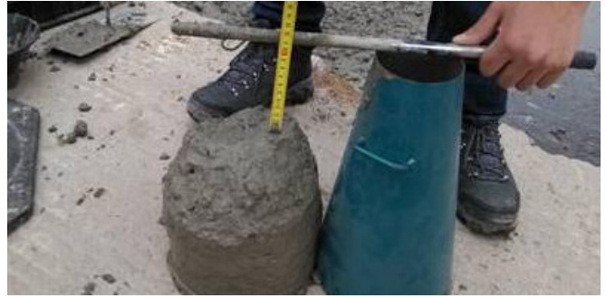
图2 坍落度试验法
