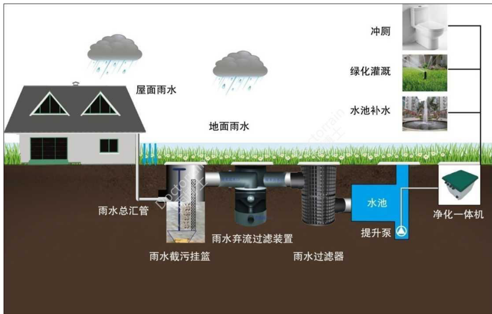
图 2 建筑雨水收集系统
