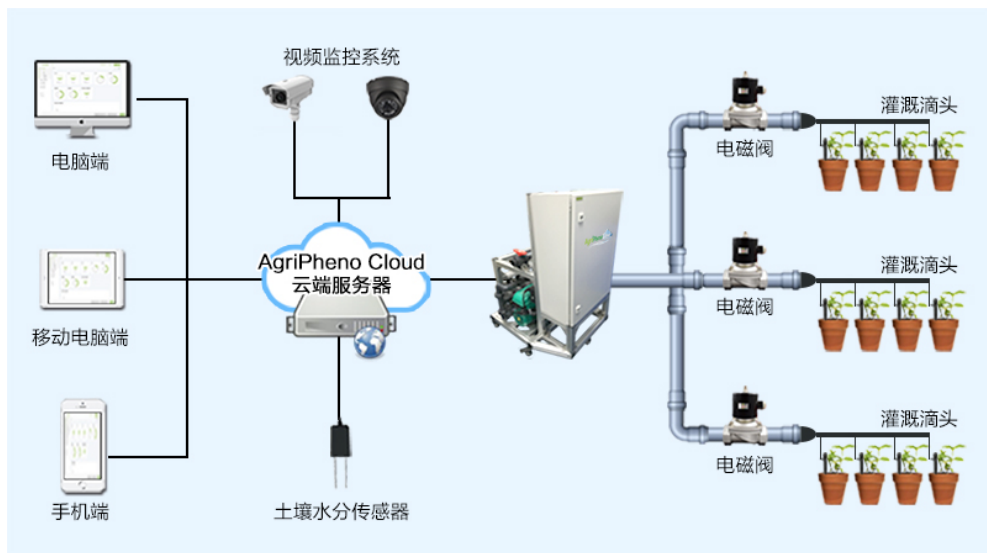
图1 自动灌溉系统结构示意图
