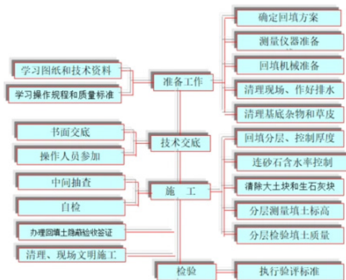
图1 土方回填工程质量控制
