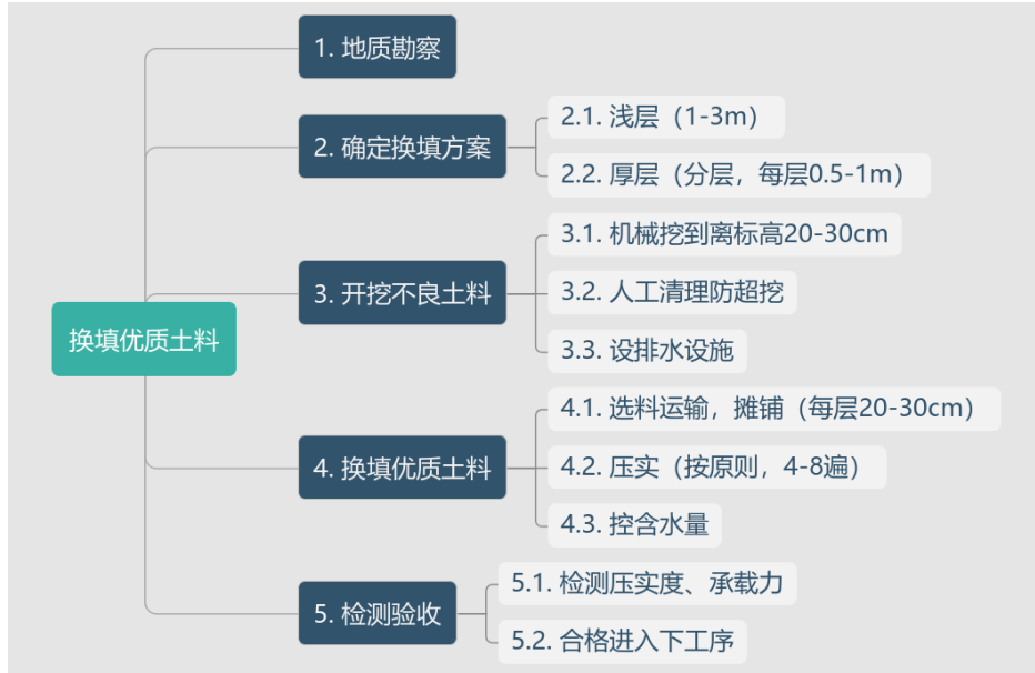
图 1. 换填优质土料施工流程图
