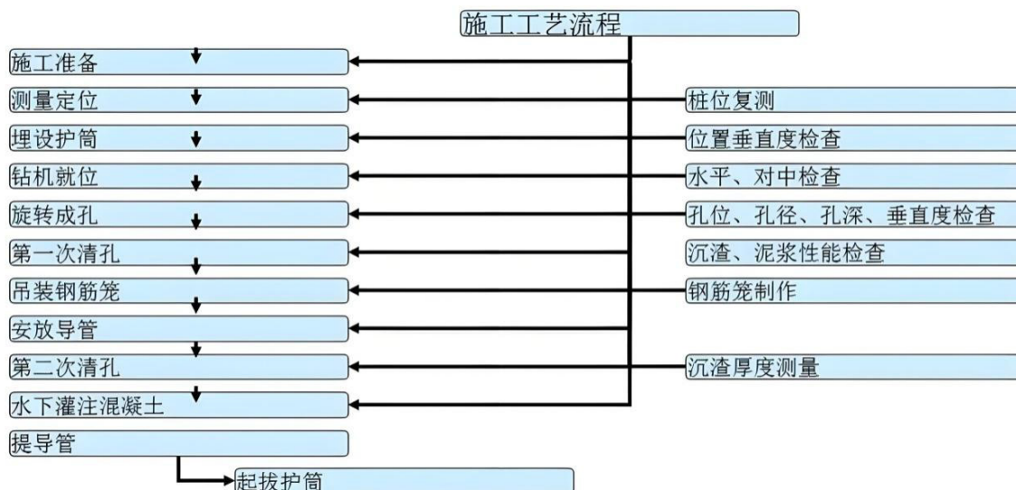
图1 成孔施工步骤图
