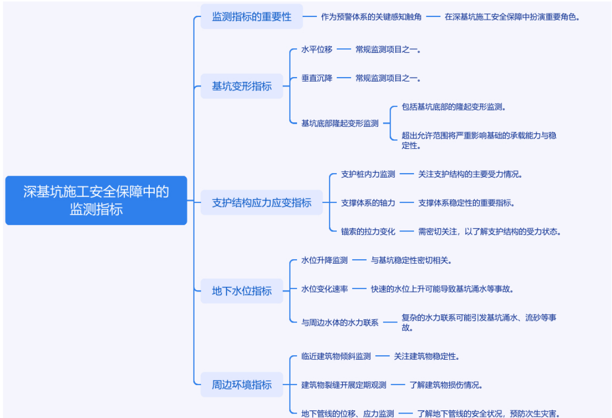
图 2 深基坑施工安全保障中的检测指标
