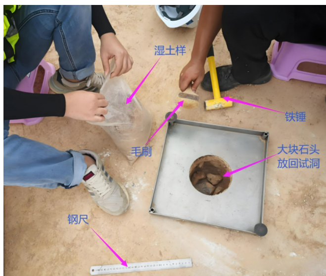
图1 灌砂法检测设施
