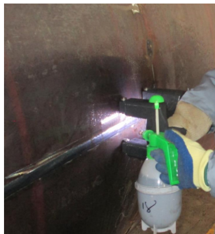
图一：焊缝磁粉探伤
