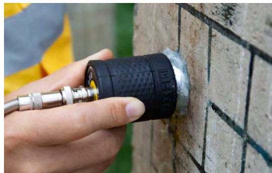
图1 超声回弹法检测混凝土强度
