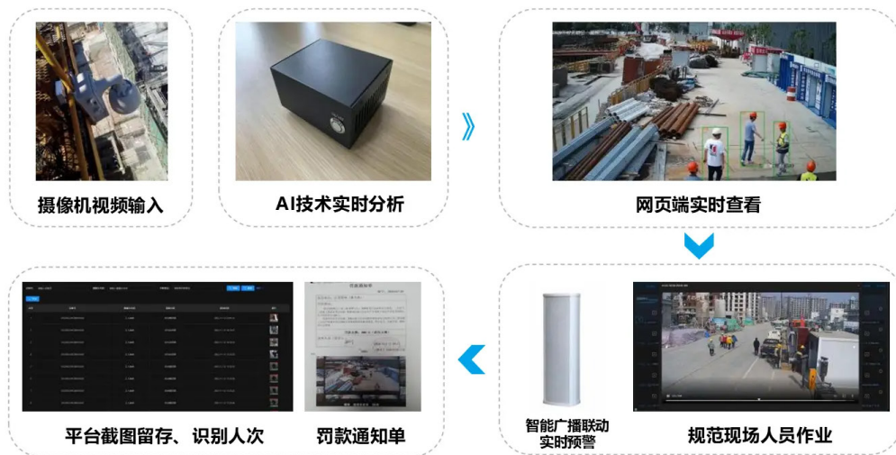
图 2：智慧工地施工现场监控
