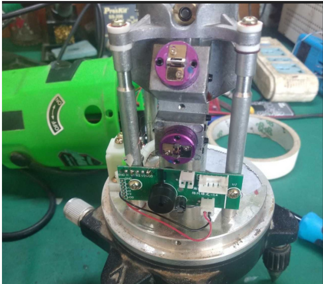
图1：水准仪拆解维修
